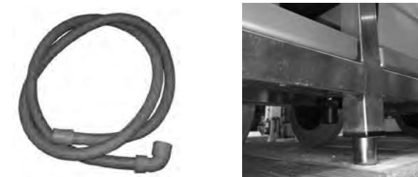
Inserire a pressione la parte con il gomito sul collegamento della parte inferiore del silo. L'altra parte dovrà essere collegata a uno scarico esterno.
